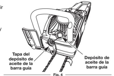
Llene el recipiente de lubricación de la barra cada vez que llene el tanque de combustible. Utilice solo aceite fabricado para trabajar dentro de un amplio rango de temperaturas sin que se necesite dilución en el depósito de aceite de la guía. No utilice aceite de motor ni ningún otro aceite a base de petróleo.
