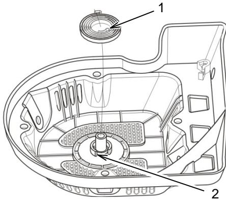
Mettez le crochet intérieur (1) du ressort du démarreur manuel dans la gorge (2) du boîtier de ce dernier et placez le ressort dans le boîtier. Maintenez le ressort en place.
