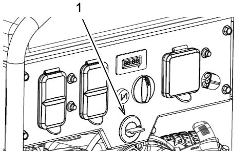
Se puede acceder a la válvula de combustible (1) sin retirar el panel de control. Para retirar la válvula de combustible, drene en un contenedor adecuado el combustible del depósito de combustible. Encienda el motor y deje que se agote el combustible. Coloque el interruptor del generador en la posición de apagado "0".
