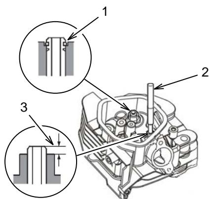
Coloque las guías de válvula nuevas del lado de la cabeza del cilindro donde está el resorte de la válvula. Use el montador de guía de válvula (2) para mover la guía de la válvula de escape hasta que el clip quede completamente asentado (1). Mueva la guía de la válvula de entrada hasta que la parte superior de la guía se extienda 1 mm por encima de la cabeza del cilindro (3). Después de la instalación revise cada guía de válvula en busca de daños. Si presentan daños, repita el proceso de
