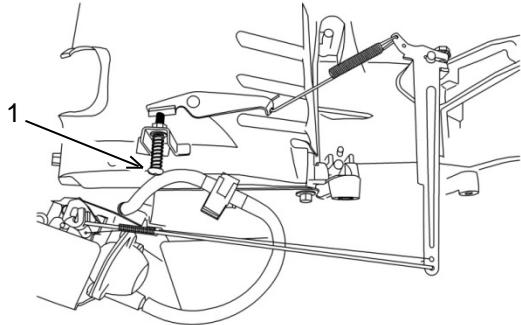
La velocidad máxima para el motor es de 3730 – 3830 rpm. Gire el tornillo de ajuste (1) en el sentido de las manecillas del reloj para aumentar la velocidad del motor. Gire el tornillo de ajuste en sentido contrario a las manecillas del reloj para disminuir la velocidad del motor.
