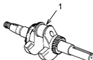
Revise el diámetro del muñón del cigüeñal (1). Un diámetro normal es de 30.190 mm. Si el diámetro es de 30.175 mm o menos, reemplace el cigüeñal.
