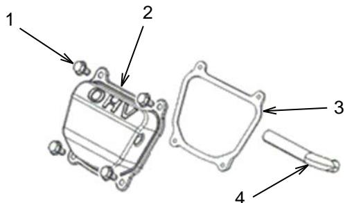
Retire los tornillos de la tapa de la válvula (1), el tubo respirador (4), la tapa de la válvula (2) y la junta de la tapa de la válvula (3).
