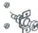
L'étrangleur est fixé à l'arrière du panneau à l'aide d'écrous de 7 mm. Retirez le bouton et le câble de l'étrangleur de la partie avant du panneau, puis retirez les écrous qui fixent l'étrangleur au panneau. Retirez la commande de l'étrangleur de l'arrière du panneau. Remontez les pièces dans l'ordre inverse.
