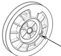
Coloque el gancho externo del resorte del arrancador retráctil en la ranura de la polea del arrancador y sostenga la polea en su lugar.
