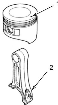
Placez la bielle dans le piston de façon à ce que son côté le plus long (2) soit aligné sur la marque de la tête de piston (1). L'insérez d'un côté du piston pour le faire ressortir de l'autre côté à travers la bielle.
