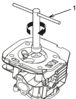
Si l'enduit à marquer montre que le siège de soupape n'est pas concentrique, utilisez une lame de découpe pour siège de soupape à 45° (1) pour créer un siège lisse et concentrique. Faites toujours tourner la lame de découpe dans le sens horaire. Utilisez une lame de découpe pour siège de soupape à 45° et une autre à 32° pour ajuster
