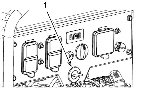
Il est possible d'accéder au robinet de carburant (1) sans retirer le panneau de commande. Pour retirer le robinet de carburant, vidangez le réservoir de carburant dans un récipient adapté. Démarrer le moteur et laissez-le tourner jusqu'à ce qu'il soit à court de carburant. Tournez le commutateur du générateur en position « 0 » (désactivée).
