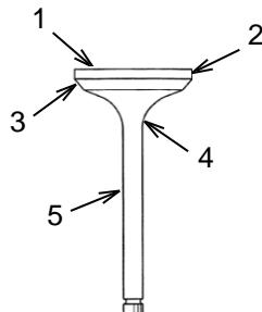
Vérifiez si les soupapes sont usées. Vérifiez si la culasse (1), le bord de la soupape (2) et le collet de la soupape (3) sont endommagés ou comportent des surfaces brûlées. Vérifiez si le col de la soupape (4) est anormalement usé. Vérifiez si la tige de soupape comporte des usures, des rainures ou des courbures. En cas de dommage, remplacez la soupape.
