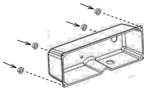
Placez la partie avant du panneau de commande sur une surface qui le protègera de tout dommage. Retirez les quatre écrous de 7 mm de l'arrière du boîtier du panneau de commande et séparez soigneusement le boîtier de la partie avant du panneau.
