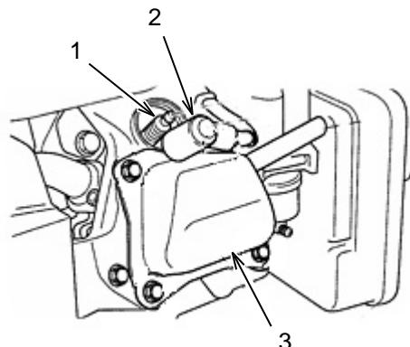
Retirez le capuchon de la bougie d'allumage (2), la bougie d'allumage (1), le couvercle de la soupape (3) et le joint du couvercle de la soupape. Tirez légèrement sur le démarreur manuel jusqu'à ce que le piston soit au point mort haut.
