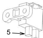
Revise la longitud de las escobillas (5). Si la longitud es 6 mm o menos, reemplace la escobilla. Para retirar la escobilla, quite el tornillo (1) y desconecte los cables. Para reinstalarla, conecte el cable rojo a la terminal "+", el cable blanco a la terminal "-", use el tornillo (1) para asegurar la nueva escobilla.
