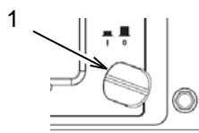
Le voyant du panneau (1) est fixé au panneau à l'aide de colle thermofusible. Débranchez le voyant du panneau du câblage et retirez la colle. Retirez le voyant du panneau de la partie avant de ce dernier.
