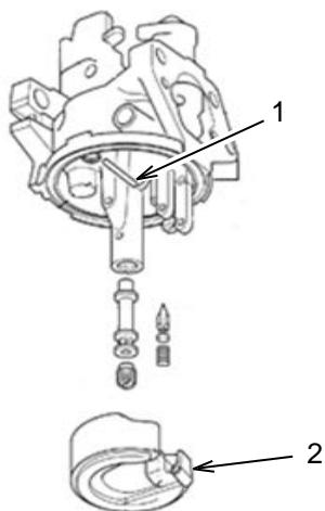
Retirez l'axe de flotteur (1), puis retirez le flotteur (2) précautionneusement en faisant attention aux petites pièces. Nettoyez les pièces internes avec un nettoyant de carburateur et de l'air comprimé.
