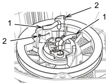
Réglez les cames d'entraînement du démarreur (1) sur la poulie du démarreur manuel, installez les ressorts de rappel (2) sur la poulie et accrochez-les sur le côté des cames d'entraînement.
