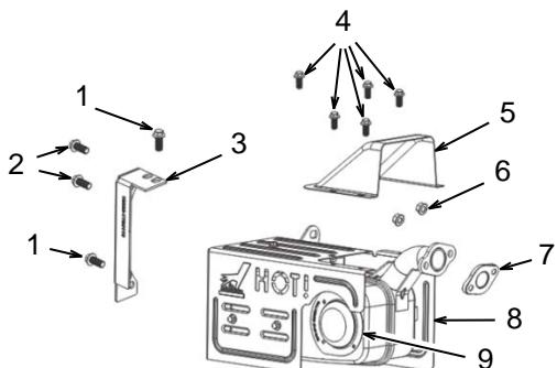
Dévissez les boulons (1) et (2), puis retirez le support (3). Dévissez les boulons (4), puis retirez le couvercle (5). Retirez les écrous (6) et soulevez le silencieux (8) des goujons de montage. Jetez le joint usagé (7). Il n'est pas recommandé de retirer le couvercle du silencieux. Réinstallez en suivant l'ordre inverse et en utilisant un nouveau joint (7). Pour l'entretien du pare-étincelles, consultez la section Pare-étincelles – Inspection/Nettoyage/Remplacement.
