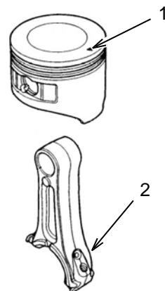
Coloque la biela en el pistón de modo que el lado más largo de la biela (2) quede alineado con la marca en la cabeza del pistón (1). Inserte por un lado del pistón, a través de la biela, y después a través del otro lado del pistón.
