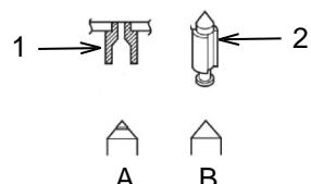
Revise el asiento de la válvula del flotador (1) y la válvula del flotador (2) en busca de desgaste. La Figura A muestra una válvula de flotador desgastada que necesita reemplazo. La figura B muestra una válvula de flotador que puede seguir siendo utilizada.
