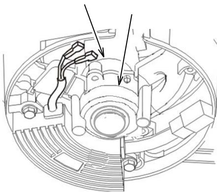
Retirez la brosse. Utilisez un ohmmètre ou un multimètre pour mesurer la résistance de la bague collectrice aux points indiqués. La résistance doit être de  $58,5 \Omega \pm 10\%$  à  $25^\circ\text{C}$ . Si la résistance est hors du seuil de tolérance, nettoyez la bague collectrice et réessayez. Si nécessaire, remplacez le générateur.
