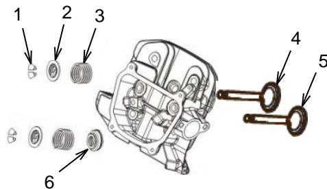
**Nota:** No retire los retenedores (2) mientras la cabeza sigue en el motor o las válvulas caerán al cilindro.
