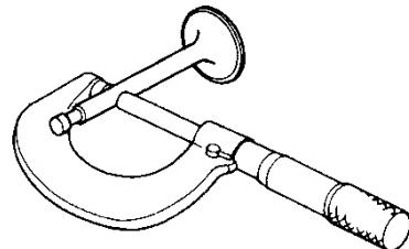
Utilisez un micromètre pour mesurer le diamètre externe de la tige de la soupape. Reportez-vous au tableau suivant.
