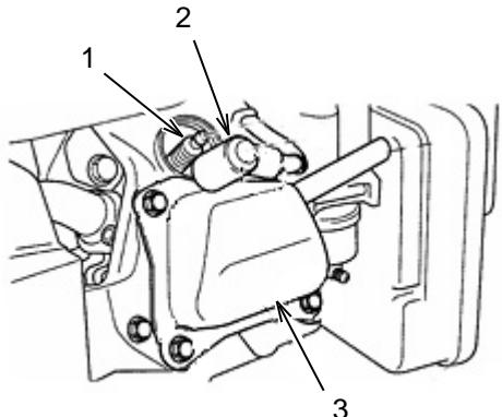
Retire el capuchón de la bujía (2), la bujía (1), la tapa de la válvula (3) y la junta de la tapa de la válvula. Jale ligeramente el arrancador retráctil hasta que el pistón quede en el punto muerto superior.
