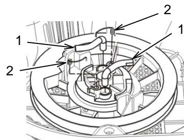
Coloque las levas de impulsión de arranque (1) en la polea del arrancador retráctil e instale los resortes de retorno (2) en la polea y engáncelos en el lado de las levas de impulsión.
