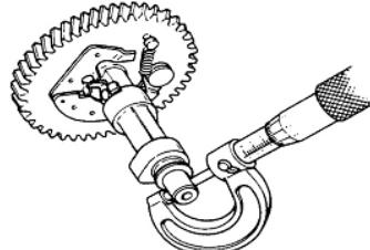
Mida el diámetro exterior del árbol de levas. El diámetro normal es de 13.984 mm. Si el diámetro es de 13.916 mm o menor, reemplazar el árbol de levas.
