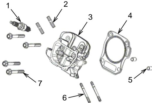
Retire la bujía (1). Retire los tornillos de la cabeza del cilindro (7) y retire la cabeza del cilindro (3). Retire la junta de la cabeza del cilindro (4) y deseche la junta usada. Retire los pernos de sujeción (5) y sepárelos a un lado. Los pasadores (2) y (6) pueden dejarse en la cabeza del cilindro para este procedimiento.
