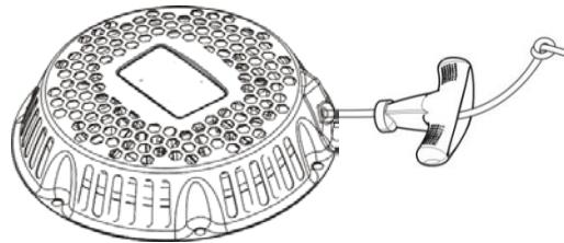
Enroulez le cordon autour de la poulie. Tirez légèrement sur le cordon et placez son extrémité dans le logement. Faites passer l'extrémité du cordon à travers la poignée. Faites un nœud et laissez le ressort tirer la poignée vers le logement. Tirez légèrement pour vérifier que le système fonctionne correctement.
