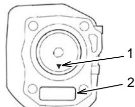
Enduire le piston, les segments et la paroi du cylindre d'huile moteur. Enfoncez les segments à l'aide d'un collier à segment et insérez le piston dans le cylindre. Vérifiez que la marque sur la tête du piston (1) s'aligne avec la marque du poussoir (2) sur le carter moteur. Utilisez un entraîneur de piston pour pousser le piston hors du collier à segment et dans le cylindre.
