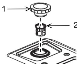
Essuyez le bouchon du réservoir de carburant (1) et la zone qui l'entoure avant de le retirer. Le fait d'essuyer le bouchon du réservoir de carburant et la zone qui l'entoure avant de le retirer permet de réduire la quantité de contaminants pouvant se retrouver dans le système de carburant.
