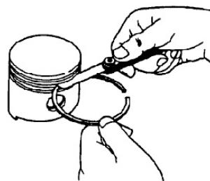
Mesurez le jeu de la bague, comme illustré. Le jeu normal est compris entre 0,015 et 0,045 mm. Si le jeu est d'au moins 0,15 mm, remplacez le piston.
