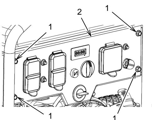
Retirez les boulons (1) et les rondelles. Tirez lentement le panneau de commande (2) vers l'avant. Vérifiez que les câbles peuvent bouger librement et ne sont pas endommagés. Marquez les câbles pour les identifier, puis débranchez les faisceaux de câbles.
