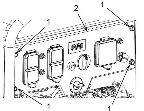
Retire los tornillos (1) y las arandelas. Jale el panel de control (2) lentamente hacia adelante. Asegúrese de que los cables se mueven libremente y no están dañados. Etiquete los cables para identificarlos y despues desconecte el cableado eléctrico.
