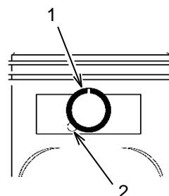
Coloque el clip del bulón del pistón (1) en la ranura del lado del pistón. Use un alicate puntiagudo para girar e introducir el clip. No alinee la ranura con el recorte (2). Repita para el otro lado.
