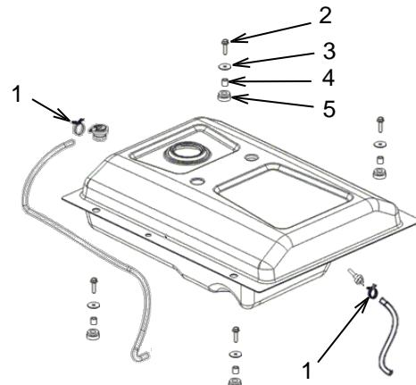
Retirez les colliers de serrage (1) et les conduites d'alimentation en carburant du capteur de retournement et du filtre à carburant. Retirez les quatre boulons (2), les rondelles (3), les bagues (4) et les manchons (5). Soulevez le réservoir de carburant.
