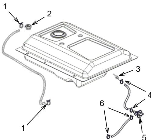
Drene el combustible del depósito de combustible en un contenedor adecuado. Encienda el motor y deje que se agote el combustible. Coloque el interruptor del generador en la posición de apagado "0".
