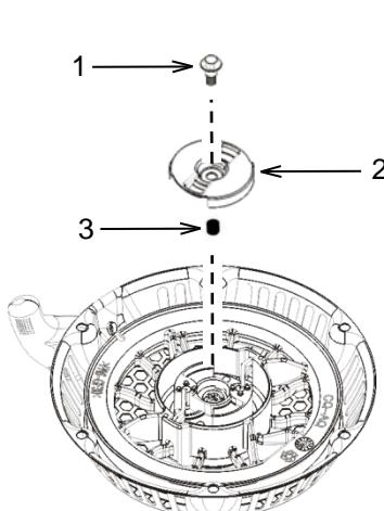
Coloque el resorte (3), la guía de impulsión (2) y el tornillo de fijación (1). Apriete el tornillo de fijación a  $9\pm1$  N·m (6-7 lb ft).
