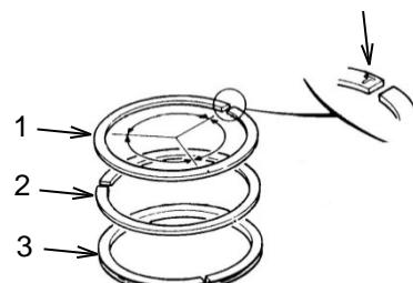
Los anillos del pistón tienen una marca junto a la abertura. Use un extractor de anillo para instalar los anillos con la marca mirando hacia arriba del pistón. Asegúrese de instalar los anillos en las ranuras correctas, con el anillo de aceite (3) en la ranura inferior, el segundo anillo (2) en la ranura media, y el anillo superior (1) en
