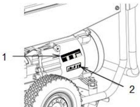
Les générateurs portables Cat sont identifiés à l'aide d'un numéro de modèle, d'un numéro de série et d'un numéro de caractéristiques de performances. Le numéro de modèle et les caractéristiques de performances se trouvent sur la plaque signalétique (1). Le numéro de série se trouve sur la plaque du numéro de série (2).
