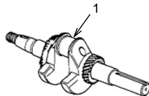
Vérifiez le diamètre de la portée du vilebrequin (1). La valeur normale est de 30,190 mm. Si le diamètre est inférieur ou égal à 30,175 mm, remplacez le vilebrequin.
