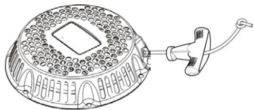
Envuelva el cable alrededor de la polea. Jale ligeramente del cable y empuje el extremo del cable a través de la carcasa. Después empuje el extremo del cable a través de la manija. Amarre un nudo en el extremo del cable y deje que el resorte jale la manija de regreso a la carcasa. Jale ligeramente para asegurarse de que el ensamblaje está funcionando adecuadamente.
