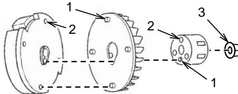
Alinee los pernos de posicionamiento (1) de la copa de arranque y de ambos lados del impulsor con los orificios (2) de la copa de arranque y del volante de inercia. Coloque el conjunto en el cigüeñal. Asegure el conjunto al cigüeñal con tuercas (3). Apriete la tuerca a  $95 \pm 4$  N·m ( $70 \pm 3$  lbft).
