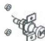
El estrangulador se sostiene en la parte trasera del panel mediante tuercas de 7 mm. Retire la perilla y el cable del estrangulador de la parte frontal del panel, y retire las tuercas que sostienen el estrangulador al panel. Retire el control del estrangulador de la parte trasera del panel. Vuelva a instalarlo en orden inverso.
