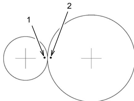
El cigüeñal y árbol de levas tienen marcas de alineación en la cara del engranaje. Use las marcas para alinear los engranajes durante el montaje. Cuando alinee las marcas, asegúrese de que el pistón está en la posición de punto muerto superior.
