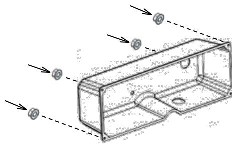
Coloque la parte frontal del panel de control sobre una superficie que permita proteger el panel de cualquier daño. Retire las 4 tuercas de 7 mm de la parte trasera de la carcasa del panel de control y cuidadosamente separe la carcasa del panel frontal.
