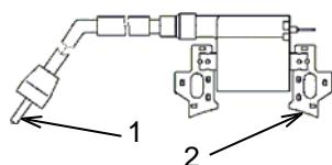
Mida la resistencia de la bobina secundaria haciendo tocar uno de los cables de un ohmímetro al cable de la bujía (1) y haciendo tocar el otro cable al marco de metal (2). Si la resistencia no está en el rango 5.9 – 7.1 Ω, sustituya la bobina.
