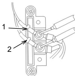
Utilisez un ohmmètre ou un multimètre sur le bornier pour mesurer la résistance de l'enroulement principal. Placez le compteur sur le fil blanc (1) et sur le fil marron (2). La résistance doit être de  $0,35 \Omega \pm 10\%$  à  $25^\circ\text{C}$ . Si la résistance est hors du seuil de tolérance, remplacez le générateur. Mesurez la résistance des fils à la terre. La résistance doit être infinie. Si ce n'est pas le cas, remplacez le générateur.
