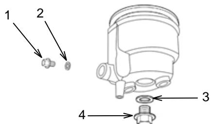
Drene el combustible de la cámara del flotador retirando el tornillo del orificio de drenado (1) y la junta (2). Use un recipiente adecuado para recibir el combustible. Deseche el combustible adecuadamente. Retire el tornillo (4) y la junta (3). Cuidadosamente retire la cámara del flotador, evitando que caiga cualquier pieza pequeña.
