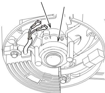
Retire la escobilla. Use un ohmímetro o multímetro para medir la resistencia del anillo colector en los puntos mostrados. La resistencia debe ser de  $58.5 \pm 10\% \Omega$  a  $25^\circ\text{C}$ . Si la resistencia está fuera del margen de tolerancia, limpie el anillo colector y haga la prueba de nuevo. Reemplace el generador de ser necesario.
