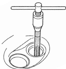
Para mejores resultados, realice este procedimiento cuando las guías de la válvula y la cabeza del cilindro estén a temperatura ambiente.
