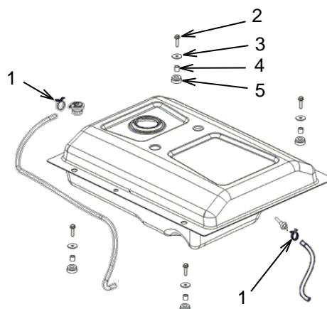
Retire las pinzas de manguera (1) y las líneas de combustible del sensor de vuelco y el filtro del combustible. Retire los cuatro tornillos (2), arandelas (3), casquillos (4) y mangas (5). Levante el depósito de combustible para retirarlo.
