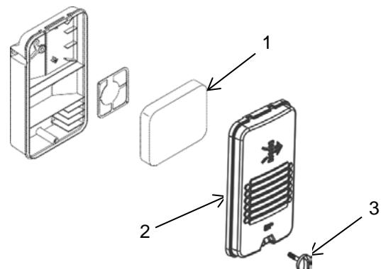
Quite el tornillo de la cubierta del filtro de aire (3) y la cubierta del filtro de aire (2). Verifique que el filtro de aire (1) esté limpio y sin daños. Si el filtro
