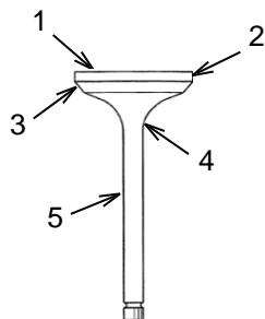
Revise las válvulas en busca de daño. Revise la cabeza de la válvula (1), la orilla de la válvula (2) y la cara de la válvula (3) en busca de áreas dañadas o quemadas. Revise el cuello de la válvula (4) en busca de desgaste inusual. Revise el vástago de la válvula (5) en busca de desgaste, marcas o dobleces. Si encuentra algún daño, reemplace la válvula.
