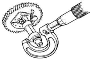
Vérifiez que l'arbre à cames n'a pas subi de dommages ni d'usure inhabituelle. Mesurez la levée des lobes de l'arbre à cames. La limite acceptable de levée est répertoriée dans le tableau ci-dessous. Si la levée est en dehors de la plage acceptable, remplacez l'arbre à cames.
