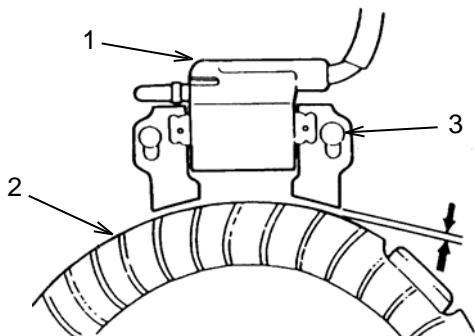
Utilisez une jauge d'épaisseur pour mesurer le jeu entre la bobine d'allumage (1) et le volant d'inertie (2). Le jeu acceptable est de 0,4 à 0,6 mm. Si ce n'est pas le cas, desserrez les vis (3) et réglez la bobine pour la remettre dans la plage. Resserrez les vis.
