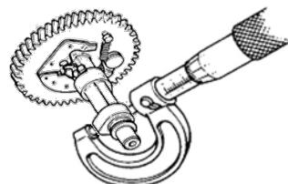
Inspeccione el árbol de levas en busca de daños o desgaste anormal. Mida el levantamiento en los lóbulos del árbol de levas. El límite aceptable para el levantamiento se muestra en la siguiente tabla. Si el levantamiento está fuera del rango aceptable, reemplace el árbol de levas.
