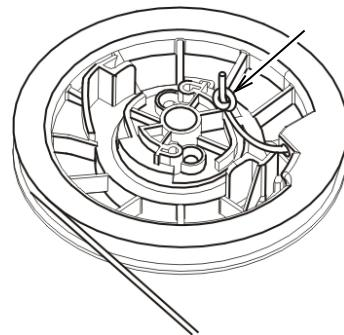
Faites passer le cordon du démarreur manuel dans le trou de la poulie de ce dernier et faites un nœud à l'extrémité du cordon, comme indiqué ci-dessus.
