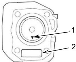
Cubra el pistón, los anillos y la pared del cilindro con aceite de motor. Use un compresor de anillo para empujar los anillos e inserte el pistón en el cilindro. Asegúrese de que la marca en la cabeza del pistón (1) se alinee con la marca del levantador (2) en el cárter. Use un montador de pistón para empujar el pistón fuera del compresor de anillo y dentro del cilindro.
