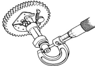
Mesurez le diamètre extérieur de l'arbre à cames. Le diamètre normal est de 13,984 mm. Si le diamètre est inférieur ou égal à 13,916 mm, remplacez l'arbre à cames.
