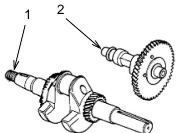
Inspectez les pignons sur le vilebrequin (1) et l'arbre à cames (2). S'ils sont usés ou si les dents sont cassées, remplacez-les. Vérifiez l'engrènement des pignons. Si l'emboîtement des pignons est trop lâche, le moteur sera plus bruyant que la normale. Il est recommandé de remplacer les pignons si l'engrènement est trop lâche. Si vous devez remplacer les pignons ou les arbres, remplacez-les un à un pour diminuer les risques de les assembler de manière incorrecte.
