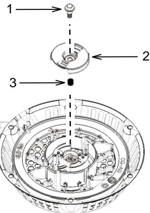
Installez le ressort (3), le guide d'entraînement (2), et la vis de fixation (1). Serrez la vis de fixation à  $9 \pm 1 \text{ N m}$  (6-7 lb pi).
