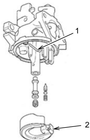
Retire la varilla del flotador (1) y retire el flotador (2) cuidadosamente, evitando que caigan las piezas pequeñas. Limpie las partes internas con limpiador para carburador y aire comprimido.
