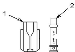
Inspeccione el inyector principal de combustible (1) y la boquilla principal de combustible (2). Si presentan desgaste, reemplácelos.
