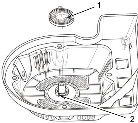
Coloque el gancho interno (1) del resorte del arrancador retráctil en la ranura (2) de la carcasa del arrancador y coloque el resorte del arrancador en la carcasa. Sostenga el resorte en su lugar.
