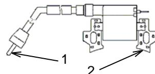
Mesurez la résistance de la bobine secondaire en connectant un fil d'un ohmmètre au câble de bougie (1) et en connectant l'autre fil au châssis métallique (2). Si la résistance est en dehors de la plage de 5,9 à 7,1  $\Omega$ , remplacez la bobine.
