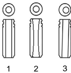
Vérifiez l'alésage du guide de soupape. Insérez la soupape et vérifiez qu'elle bouge facilement à travers l'orifice sans aucune oscillation. La figure 1 illustre un bon guide de soupape. La figure 2 illustre un guide anormalement usé qui entraîne l'oscillation de la soupape. À terme, la culasse peut se briser et tomber dans la chambre de combustion, endommageant le moteur. Ce guide de soupape doit être alésé ou
