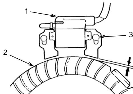
Use una galga de espesores para medir la distancia entre la bobina de arranque (1) y el volante de inercia (2). La holgura debe ser de 0.4 - 0.6 mm. Si la holgura está fuera del rango aceptable, afloje los tornillos (3) y mueva la bobina de manera que la holgura esté dentro del rango. Vuelva a apretar los tornillos.
