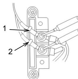
En el bloque de terminales, use un ohmímetro o multímetro para medir la resistencia del devanado principal. Coloque el medidor entre el cable blanco (1) y el cable café (2). La resistencia debe ser de  $0.35 \pm 10\% \Omega$  a  $25^\circ\text{C}$ . Si la resistencia está fuera del margen de tolerancia, reemplace el generador. Mida la resistencia de los cables a la conexión a tierra. La resistencia debe ser infinita. Si la resistencia no es infinita, reemplace el generador.
