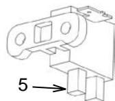
Vérifiez la longueur des brosses (5). Remplacez-la si la longueur est inférieure ou égale à 6 mm. Pour enlever la brosse, retirez les boulons (1) et débranchez les fils. Pour procéder à la réinstallation, branchez le fil rouge à la borne « + » et le fil blanc à la borne « - », puis fixez la nouvelle brosse à l'aide d'un boulon (1).
