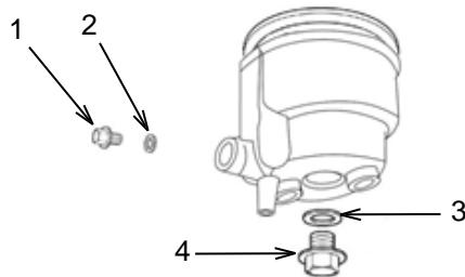
Vidangez le carburant de la cuve à niveau constant en retirant le boulon de vidange (1) et le joint (2). Utilisez un récipient adapté pour récupérer le carburant. Éliminez correctement le carburant. Retirez le boulon (4) et le joint (3). Retirez prudemment la cuve à niveau constant et retenez les petites pièces qui sont susceptibles de tomber.
