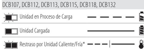
\*La luz roja continuará parpadeando, pero una luz indicadora amarilla estará iluminada durante esta operación. Una vez que la batería haya llegado a una temperatura apropiada, la luz amarilla se apagará y el cargador continuará con el procedimiento de carga.
