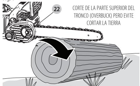
CORTE DE LA PARTE SUPERIOR DEL TRONCO (OVERBUCK) PERO EVITE CORTAR LA TIERRA
