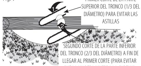
PRIMER CORTE DE LA PARTE SUPERIOR DEL TRONCO (1/3 DEL DIÁMETRO) PARA EVITAR LAS ASTILLAS
