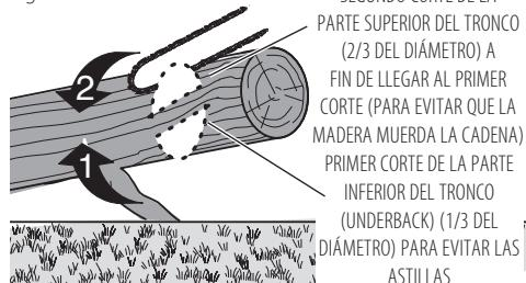
SEGUNDO CORTE DE LA PARTE SUPERIOR DEL TRONCO (2/3 DEL DIÁMETRO) A FIN DE LLEGAR AL PRIMER CORTE (PARA EVITAR QUE LA MADERA MUERDA LA CADENA)
