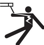
Lorsque l'on appuie sur la gâchette, l'électrode et le mécanisme de traction se trouvent sous alimentation électrique par rapport au travail et à la masse et ils le restent pendant plusieurs secondes après que la gâchette du pistolet ait été relâchée.
