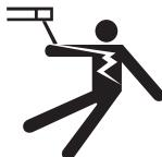
Cuando se activa, el electrodo y mecanismo de impulsión están eléctricamente "calientes" en relación al trabajo y aterrizamiento, y permanecen "calientes" varios segundos después de que se soltó el gatillo.
