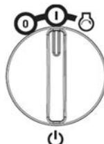
Placez le commutateur du générateur sur la position de démarrage « 0 » et maintenez-le sur cette position jusqu'à ce qu'il démarre (pendant 5 secondes maximum). Lorsque vous lâchez le commutateur, celui-ci revient sur la position « I » (activé). Pour éteindre le groupe électrogène, tournez le commutateur du groupe électrogène en position « 0 » (désactivé).
