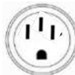
La salida de 120/240 V CA está protegida contra sobrecarga por un interruptor de doble polo de 48 A. Use un enchufe NEMA L14-50 con este receptáculo. Use el receptáculo para alimentar una carga eléctrica de 120 V CA o 240 V CA, monofásica, de 60 Hz que requiera 50 amperios de corriente.
