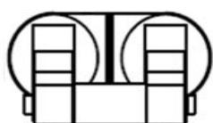
Les prises de 240 V sont équipées d'un disjoncteur supplémentaire qui isole ces prises sur le panneau. Ce disjoncteur doit se trouver en position « O » (activé) pour que l'unité fournit de la puissance.
