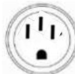
La prise 120/240 V CA est protégée contre les surcharges par un disjoncteur bipolaire 48 A. Utilisez une fiche NEMA L14-50 avec ce réceptacle. Utilisez le réceptacle pour alimenter une charge électrique de 120 V CA ou de 240 V CA, monophasée, 60 Hz nécessitant 50 ampères de courant.
