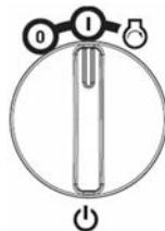
Coloque el interruptor del generador en la posición de arranque "O" y sosténgalo hasta que se encienda el motor (no más de 5 segundos). Al soltar el interruptor, regresará automáticamente a la posición de encendido "I". Para apagar el generador, gire el interruptor a la posición de apagado "O".
